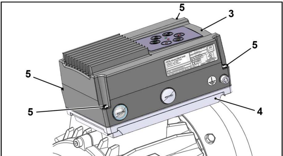
2. Setzen Sie den Kühlkörper (3) vorsichtig auf die Adapterplatte (4) auf.
