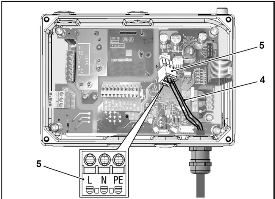
3. Schließen Sie die Netzleitungen (4) an den Netzstecker (5) wie folgt an:
