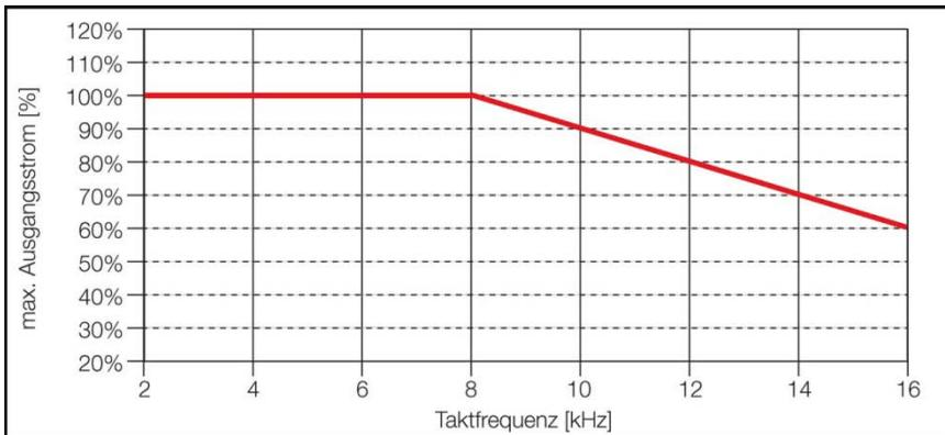
Abb.: 34 Derating des maximalen Ausgangsstroms aufgrund der Taktfrequenz
