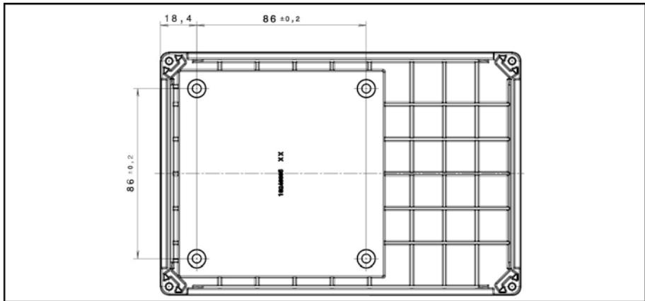
Abb.: 36 Bohrbild Standard-Wand-Adapterplatte BG  $\alpha$
