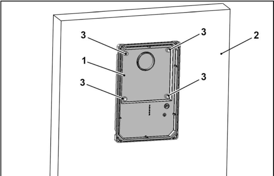
Abb.: 21 Befestigung der Adapterplatte an der Wand
