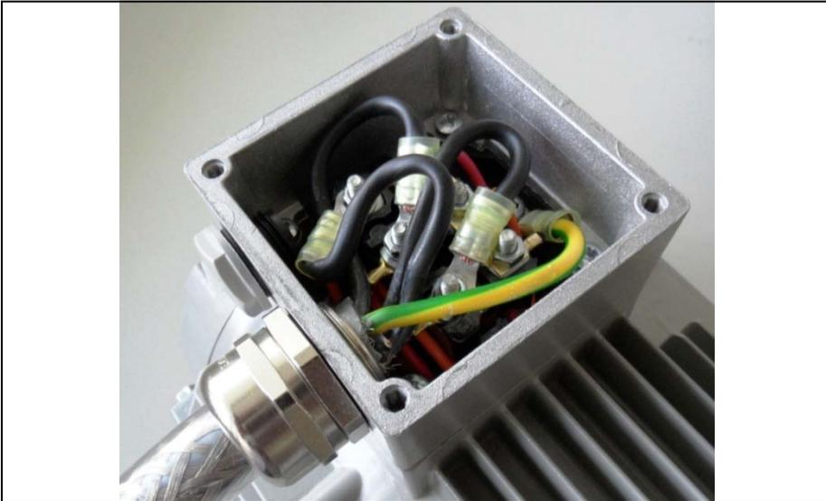
Abb.: 20 Verdrahtung am Motoranschlusskasten
