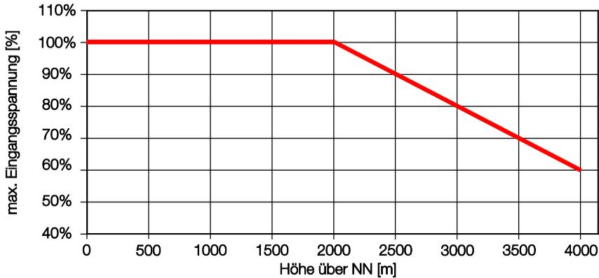
Abb.: 33 Derating der maximalen Eingangsspannung aufgrund der Aufstellhöhe
