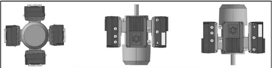
Abb.: 9 Motoreinbaulage / Zulässige Ausrichtung
