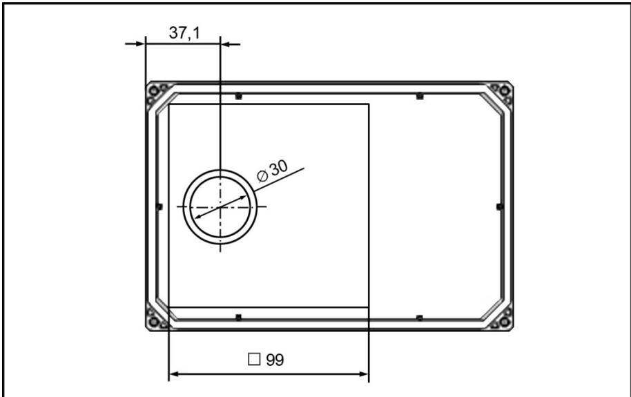
Abb.: 35 Bohrbild Standard-Adapterplatte BG α
