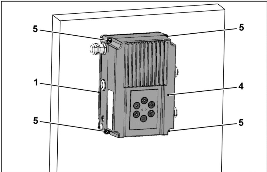
Abb.: 22 Antriebsregler aufsetzen (Wandmontage)
